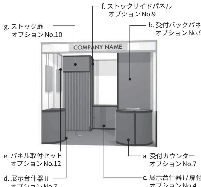
システムパネルはビニールコーティング仕上げ(白色)のベニヤ板パネルのため、釘打ち、穴開け、経師貼、切断等の加工等の直接装飾を施すことができません。
